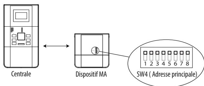
La configuration des dispositifs doit se faire hors alimentation. Vérifier que tous les interrupteurs de SW4 sont sur ON. Basculer l'interrupteur POWER sur ON, la LED s'allume un bref instant. S'assurer que la centrale est en mode Appairage (voir notice de la centrale). Maintenir le bouton fonction BP1 pendant 4 secondes pour appairer le dispositif. La centrale affiche «MA relié» Placer les DISPOSITIFS D'ALARME RADIO dans leurs emplacements finaux (Voir partie Installation)
