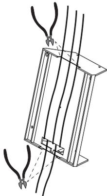
Couper avec une pince coupante les bords comme illustré à gauche afin de permettre le passage de câbles. Effectuer une boucle avec les câbles provenant de l'étage supérieur comme représenté à droite pour éviter une détérioration de la carte en cas de présence d'humidité sur les câbles.
