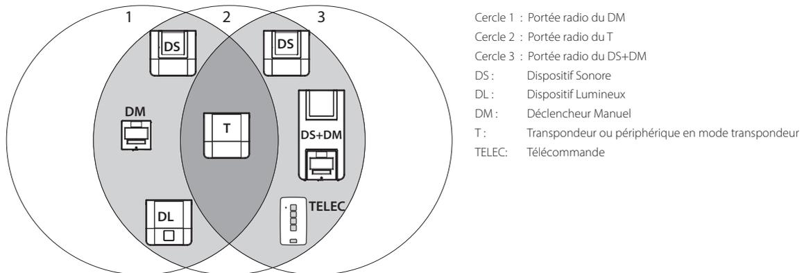
Le principe de fonctionnement de la gamme RF est basé sur des émetteurs (les DM et/ou télécommandes) et des récepteurs (sirène, flash, ...). Tous les récepteurs à portée radio directe ou indirecte (via transpondeur(s)) des émetteurs sont déclenchés.
