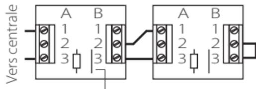
Couper le strap sur le dernier DM en cas de surveillance de ligne ou remplacer le shunt en B2-B3 du dernier DM par la résistance désirée.
