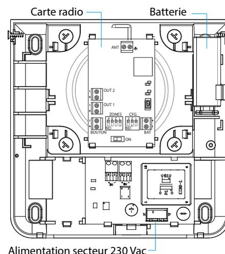
Effectuer le raccordement au 230 Vac et connecter la batterie.
